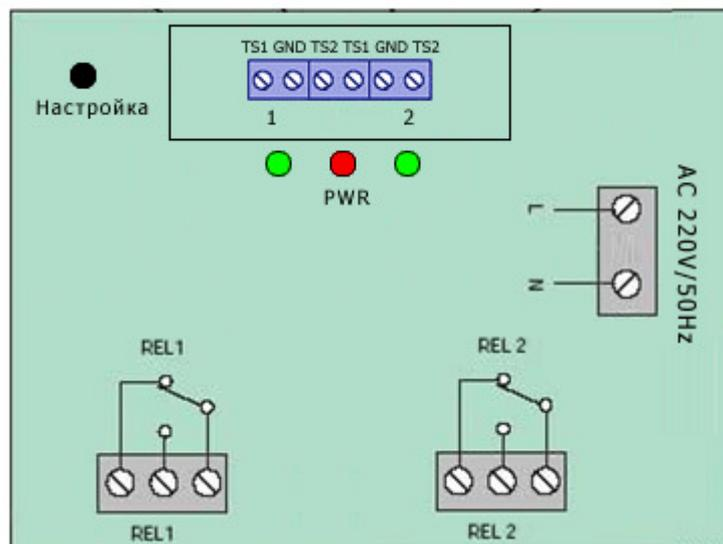
**Осторожно!** При работе устройства, на всех внутренних деталях и проводниках, кроме выходных контактов, присутствует сетевое напряжение.
