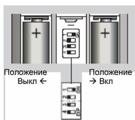
За первый канал датчика отвечают движковые выключатели 1 и 2, а за второй – 3 и 4.
